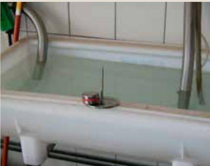
Diagnostic de la température de nettoyage de l'installation de traite (capteurs dans le bac de lavage).
